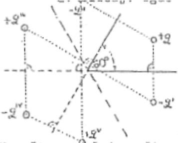
Slika pokazuje, kada se precizno crta, da je ukupan broj tačkastih nanelektrisanja 6. ovaj broj se može dobiti kao
