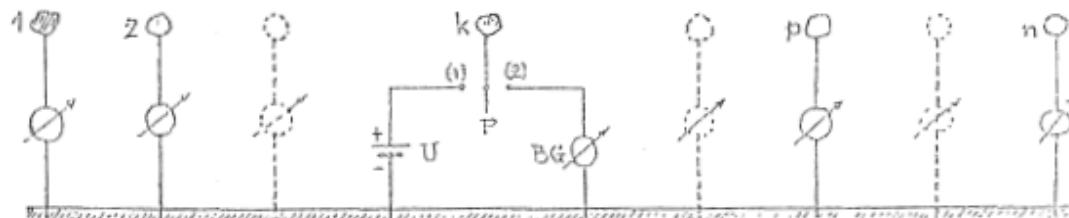
Naime, sva tijela datog sistema, sem k-tog, „uzemljimo“ preko balističkih galvanometara ( $BG_i$ ). (To su vrlo osjetljivi instrumenti za registrovanje i najmanjih količina nanelektrisanja). Tijelo k, preko preklopnika P možemo priključiti na izvor poznatog napona odnosno na balistički galvanometar. Izrazi za koeficijente su:
