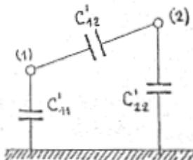
Naime,  $C_{11}$  je kapacitet između prvog provodnika i zemlje;  $C_{22}$  - kapacitet drugog provodnika i zemlje;  $C_{12} = C_{21}$  - kapacitet između samih provodnika. Pri tome je  $C_{12}$  vezan paralelno sa rednom vezom  $C_{11}$  i  $C_{22}$ , te je ukupna ili pogonska kapacitivnost data sa
